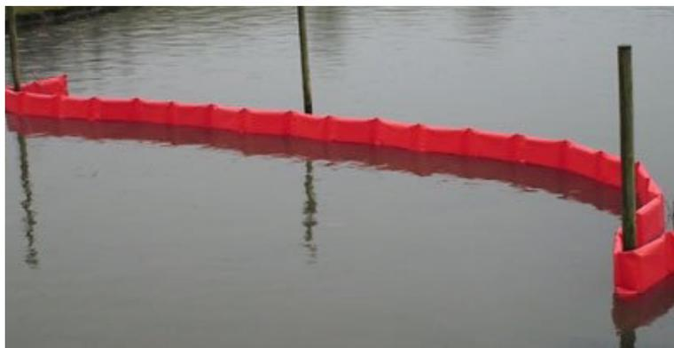
Боновые заграждения с плоской поплавковой камерой используются для быстрой локализации нефтяных разливов в акватории портов, водохранилищ, на затонах, реках и в открытом море.
