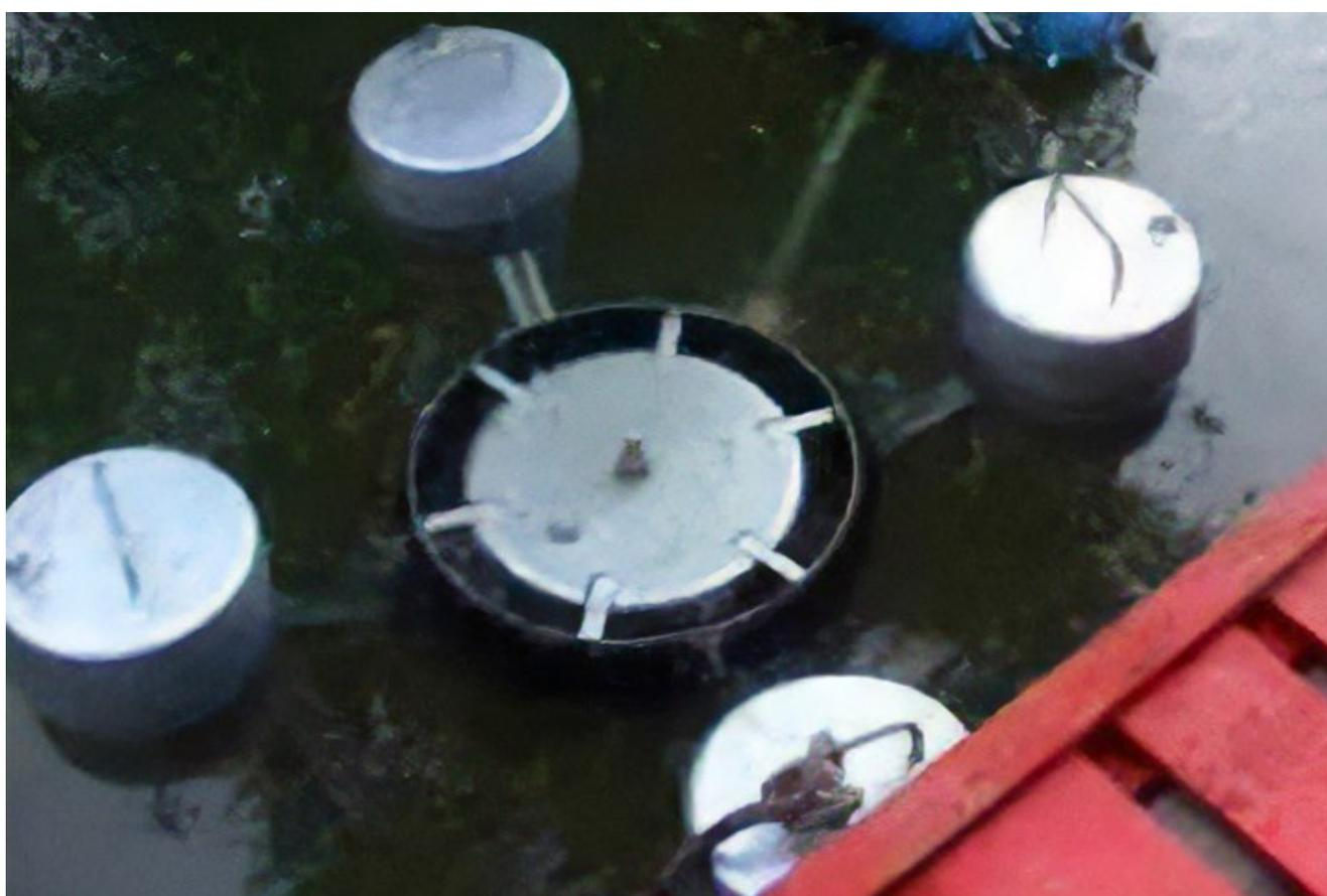
AQUA скиммеры могут устанавливаться в комплекте с боновыми заграждениями при операциях ЛАРН. Также предназначены для стационарного использования в отстойниках, резервуарах.
